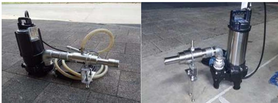
常識的にはYJノズルの酸素溶解効率を50%として、6.9m<sup>3</sup>/minの純酸素が必要酸素量として必要ですが、今回の場合、YJ-21(100/min)×12本=1.2m<sup>3</sup>/minの酸素でBOD負荷5,000kg・BOD/日を分解しており、これは常識的に必要な必要酸素量のわずか1/5以下にすぎないことがわかります。
