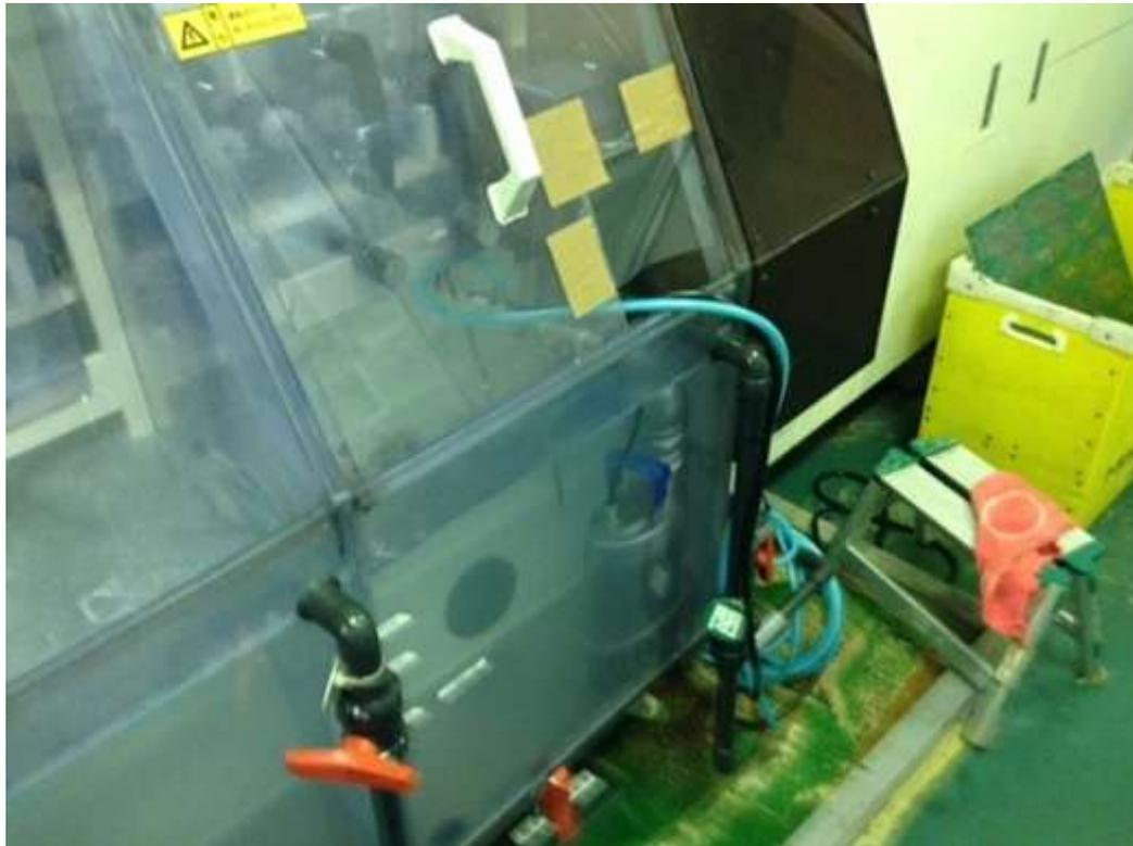
ファインバブル発生装置「YJ ノズル」をS R現像ライン最終水洗槽へ設置
