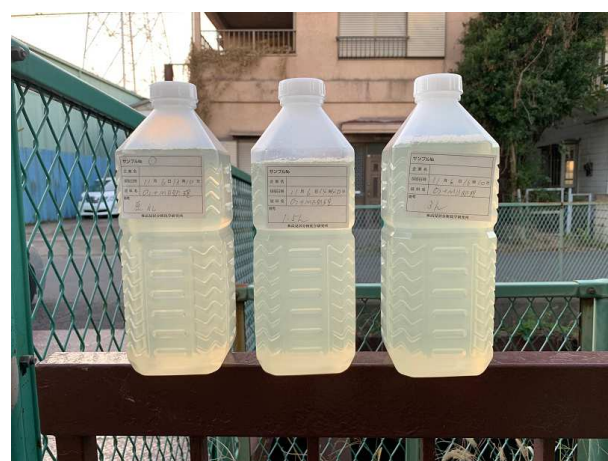
4 - 開始 180 分後の状態 色はほとんど変わらず、時間が経つと SS が沈殿する
