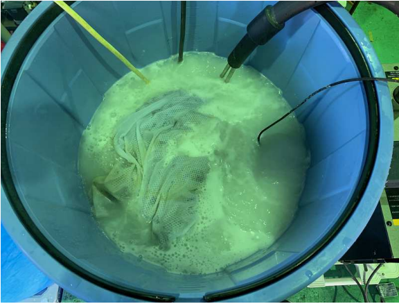
1 - 空気マイクロ・ナノバブルとACB キャリアを投入 水温は30℃維持
