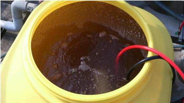
200リットル ポリタンクに原水を入れ、マイクロバブルを発生させた状態
