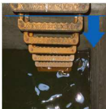
マイクロナノバブル設置時に浸漬していない部分は、表面の汚れが目立っています。 水没部の汚れ具合は上記露出部と大差が無い状態でした。
