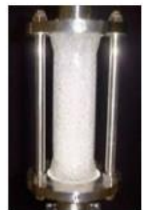
溶存酸素除去システムで 処理直後の状態
