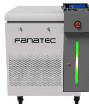
レーザークリーナーモード (錆、塗料、汚れ、黒皮等の除去、脱脂)
